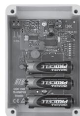
per costa meccanica o elettrica da alimentare con 3 batterie stilo tipo AA da 1,5V non incluse.
