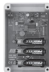
Für mechanische oder elektrische Kontakteile, Versorgung mit Mignon - Batterien vom Typ AA zu 1,5V, nicht im Lieferumfang enthalten.
