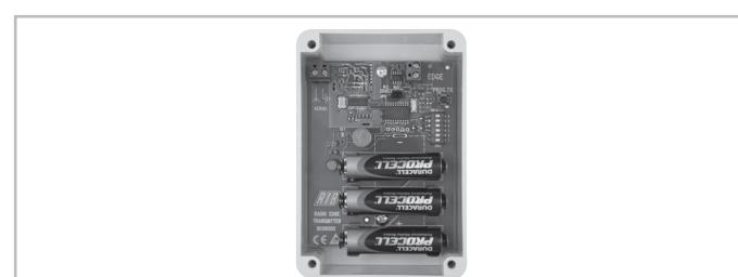
per costa meccanica o elettrica da alimentare con 3 batterie stilo tipo AA da 1,5V non incluse.
