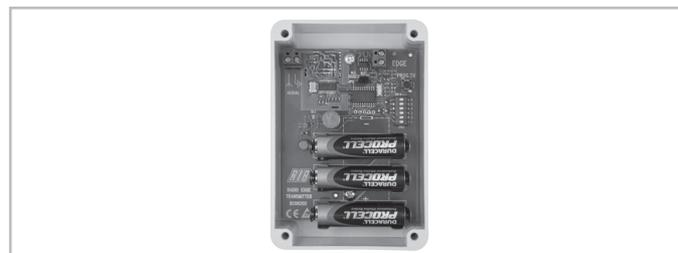
Für mechanische oder elektrische Kontaktleiste, Versorgung mit Mignon - Batterien vom Typ AA zu 1,5V, nicht im Lieferumfang enthalten.
