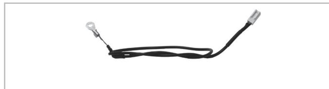
Sonda di rilevamento temperatura ambiente motore per riscaldamento dello stesso in climi particolarmente freddi, fino a -30°C (collegare a connettore J6). cod. ACG4665
