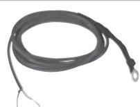
Sonda di rilevamento temperatura ambiente motore per riscaldamento dello stesso in climi particolarmente freddi, fino a -30°C (collegare a connettore J6). cod. ACG4666
