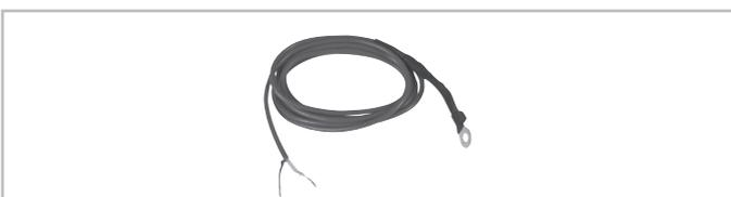
Sonda relevación temperatura ambiente motor para calefacción del mismo en climas particularmente fríos, hasta -30°C (conector al J6). cód. ACG4666
